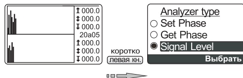
Рис. 53 – Включение в центральном пульте №2 режима анализатора сети для оценки уровня сигнала
